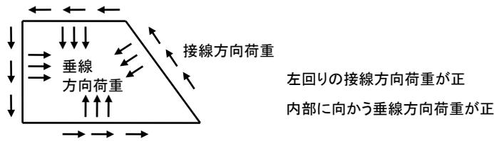
図 6-2-6 外形線分の中に作用する集中荷重
