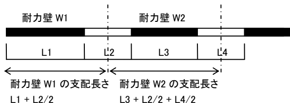
図 2.2.7-1 耐力壁の荷重支配長さ
