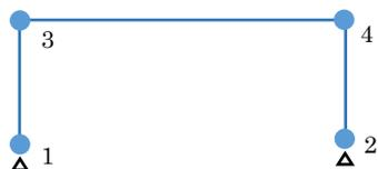
なお、上記の手順で「節点 2 → 節点 4」は「節点 4 → 節点 2」の順にタップしても同じですが、その場合は「部材 1-3」と部材軸方向が反転します。それで構わないのですが、その場合、左右の柱の応力の正負符号が変わります。できるだけ、「柱の場合は下 → 上」「梁の場合は左 → 右」のような一定のルールのもとに部材を作った方が分かりやすいでしょう。
