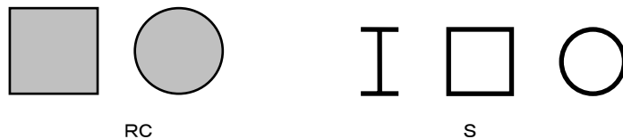
図 3.1.2-3 柱の断面形状
